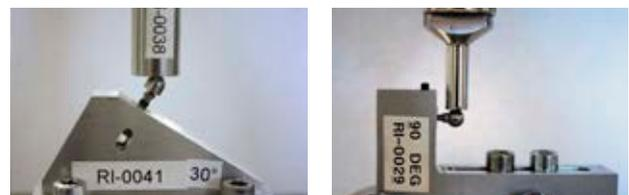
Fatigue-Test mit 30° non-axialer Last (ISO 14801:2007) und 90° non-axialer Last von DENTSPLY Sirona.
